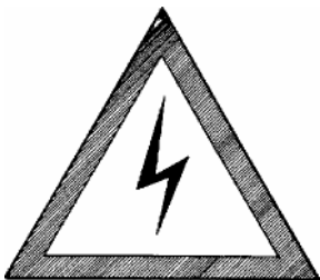
Fig. 9: Utmärkning av huvudströmbrytarens placering.
